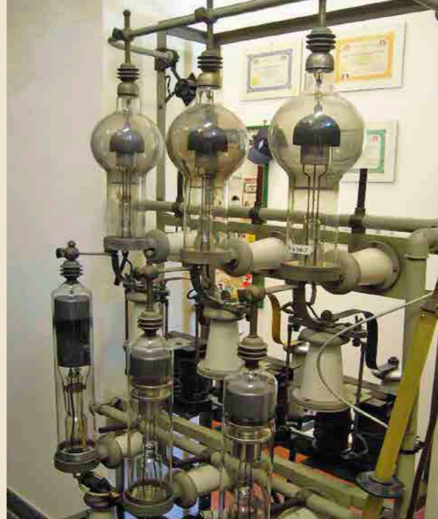
All'interno di un trasmettitore ad Onde Corte, circuito raddrizzatore con diodi a vapore di mercurio.
