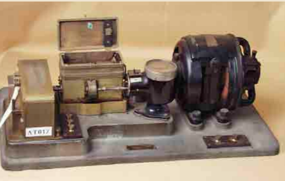
Trasmettitore telegrafico in codice Morse della Marconi's Wireless Telegraph Co. anche questo utilizzato nei primi anni della Radio Vaticana per il Servizio Telegrafico (Sala Traffico).
