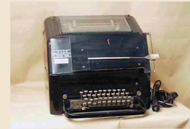
Una telescrivente della FACE, su brevetto Lorenz (Berlino) utilizzata negli anni '30 dalla Sala Traffico per i collegamenti con le Agenzie di Stampa e le Nunziature.
