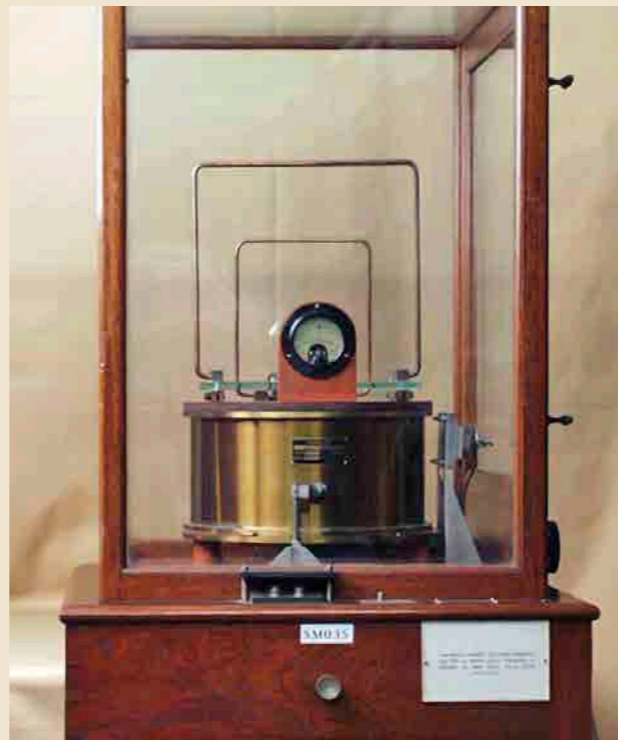
Ondametro in camera termostatica utilizzato da Marconi.
